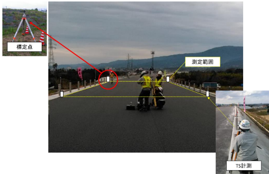
図3-25 T L Sと標定点の配置（例）
